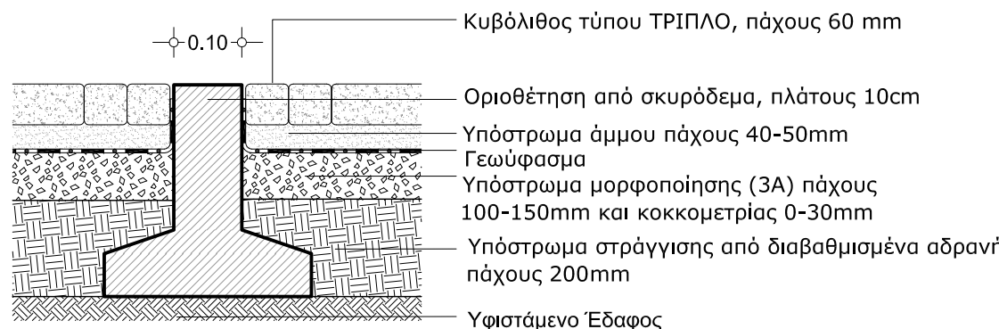
Λ07_ΥΠΟΔΟΜΗ ΔΑΠΕΔΟΥ ΑΠΟ ΚΥΒΟΛΙΘΟΥΣ ΕΓΚΑΡΣΙΑ ΤΟΜΗ ΚΛΙΜΑΚΑ: 1:10
